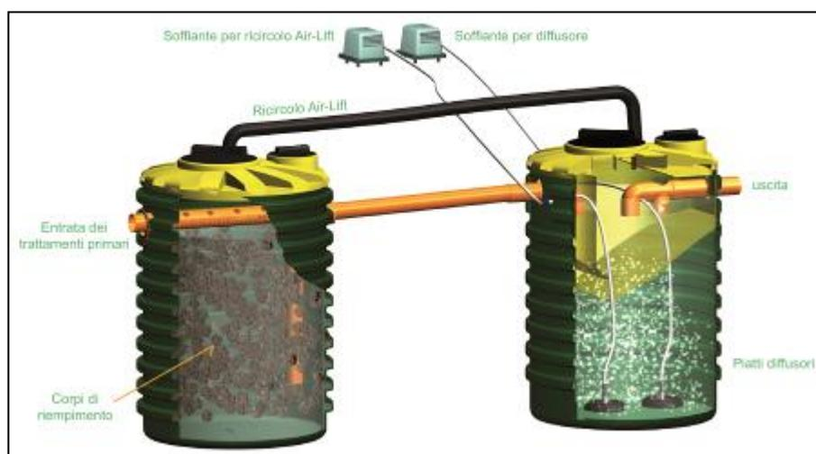
I trattamenti secondari formati da un percolatore anaerobico e da un impianto a fanghi attivi, permettono di ottenere un abbattimento vicino al 100% per quello che riguarda il carico organico e i solidi sospesi e una riduzione molto spinta del carico di azoto e di fosforo contenuti nelle acque reflue civili.
