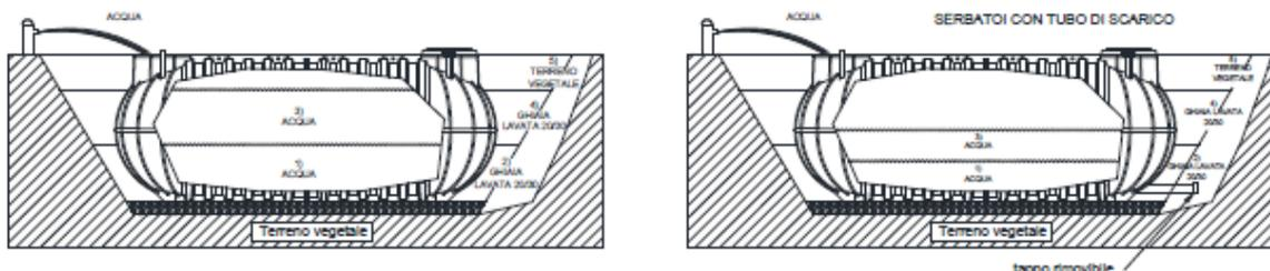
2.2 Dopo aver riempito e rinfiancato in modo adeguato il serbatoio, ricoprirlo gradualmente con del terreno vegetale (**NON di natura argillosa/limosa, NON materiale di scavo**) oppure con materiale alleggerito es. argilla espansa per 30/40cm, lasciando liberi i tappi di ispezione. In questo modo l'area interessata è pedonabile ed è vietato il transito di automezzi fino a 2m di distanza dallo scavo.
